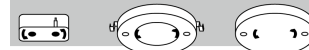
丸型引掛シーリング 引掛電線ロケット 丸型引掛シーリング
