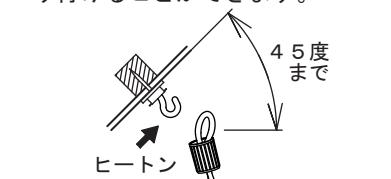
・必ずヒートンの開口部が上を向くように取り付けてください。
