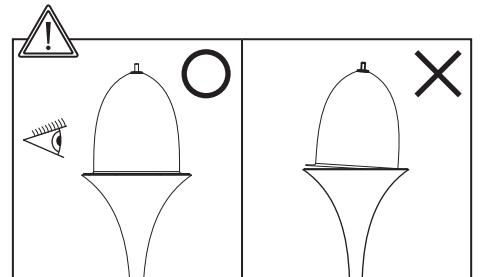
3 シェードをランプカバーにかぶせ、トップナットをしめつけ確実に固定してください。
