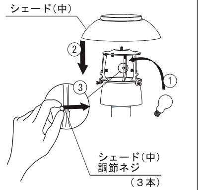
5 ランプをソケットにねじ込んでから、シェード(中)をフレームにかぶせてください。シェード(中)調節ネジ(3本)で均等に調整しながらセード(中)に軽くふれるまでしめて、シェード(中)が水平になるようにしてください。
