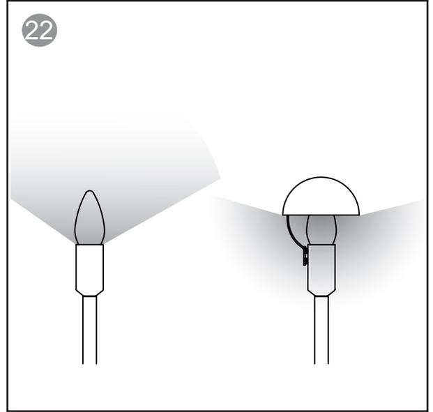
*Para las luces del aro superior el imán que sujeta las cazoletas estará fijado en el aro.*
