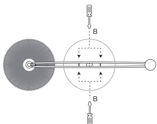
アームを大きく動かした時、重みで落ちてしまう場合は、以下の手順で固さを調整できます。
