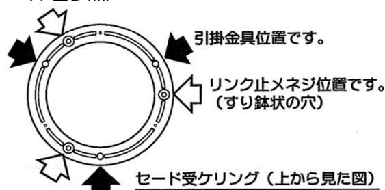
3. セード受けリングを本体にセットし、リング止めネジ（3本）を締め付けて固定してください。
