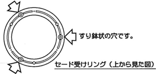
3. セード受けリングを本体にセットし、リング止めネジ（3本）を締め付けて固定してください。
