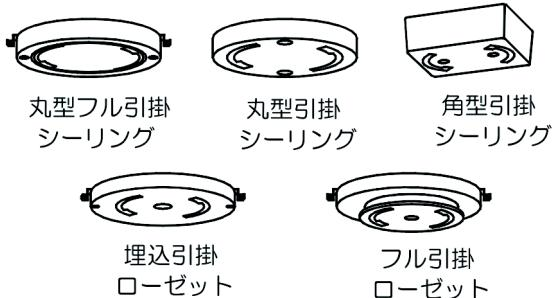
引掛けシーリングボディがついていない場合は、取付ネジ(2本)で補強材のある天井面に取付けてください。
