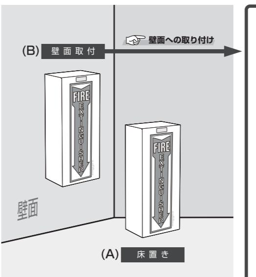
**壁面への取り付け方：**カバーを外した状態で、付属の壁面固定ネジを使用してしっかりと取り付けてください。※図を参考に必ず4ヶ所固定してください。
