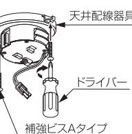
天井の補強材のある場所に補強ビスBタイプ(2本)をドライバーでしっかりと締めてください。
