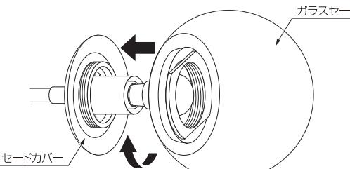
**警告** ガラスセードがしっかりとセードカバーに固定されているかを確認してください。
