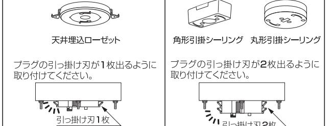
**注意** この時、回転防止ツメにプラグの引っ掛け刃が接触しないようにしてください。落下の原因になります。
