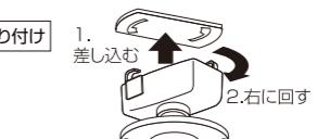
△ 取り付け及び取り外しの際に、無理な角度で回したり、強い力で扱うとプラグが破損します。十分注意してお取り扱いください。
