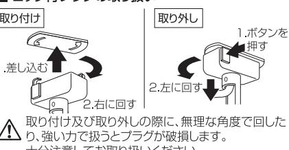
取り付け及び取り外しの際に、無理な角度で回したり、強い力を扱うとプラグが破損します。
