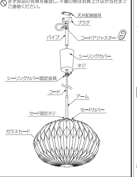
③セードカバーを下ろし、図のようにプレートとはさむようにセード固定ネジで固定してください。
