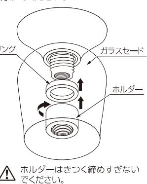
**注 意 CAU.** ガラスセードの落下、破損、損傷等の危険がありますので、ガラスセード取り付け時は必ず二人で行ってください。
